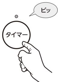
湿度表示中にタイマーボタンを押すと、表示部に残りの運転時間を約10秒間表示します。（例：タイマーを5時間後に設定してから2時間経過したときは、[03]を表示します。）
