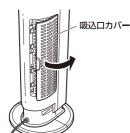
2 吸込ロカバーのツメから 3 フィルターと脱臭フィルターを外します。
