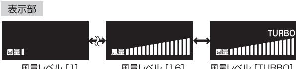
※[TURBO] の設定を解除するときは、以下のいずれかの操作をする。
