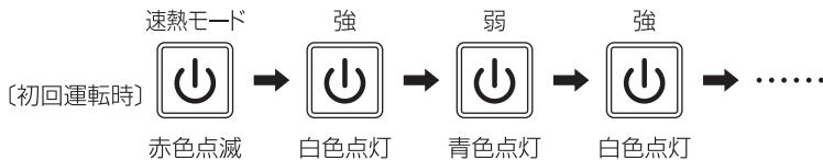
※運転開始後、1時間経過すると自動的に運転が停止します。(1時間自動OFFタイマー)
