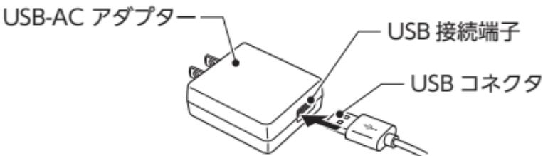
3. USBケーブルのマイクロUSBコネクタを、本体のマイクロUSB接続端子に差し込む
