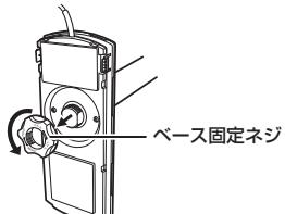
③本体前方のツメとベース前方の溝が合うように本体を斜めに傾けてはめ込みます。
