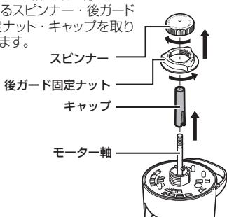
③後ガード固定ナットを時計回りに回して締め付けます。
