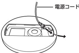
④本体後方のツメとベース後方の溝が合うようにはめ込みます。
