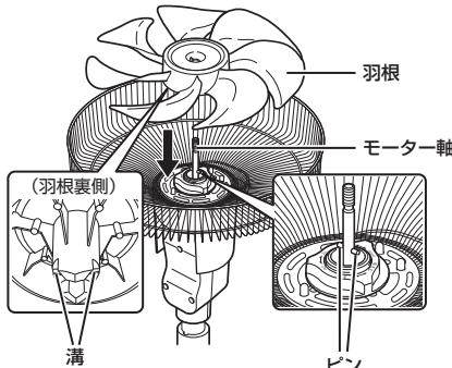
②スピナーナーを反時計回りに回して締め付けます。
