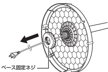
②電源コードを引き出しながら、スタンド取付穴の突起とスタンドの溝が合うようにめ込みます。
