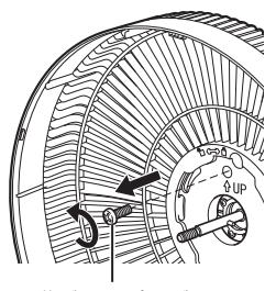
②後ガードを反時計回りに回してロックを解除します。
