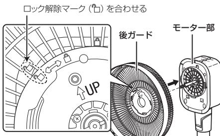
②後ガードを時計回りに回転が止まるまで回してロックします。
