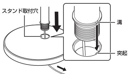
④底面からベース固定ネジを取り付け、電源コードの保護チューブ部分をベースの溝に通します。
