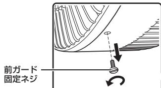
②前ガードを反時計回りに回転が止まるまで回し、取り外します。
