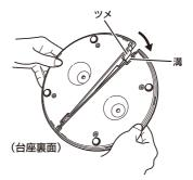
3 台座表面のくぼみと本体底面の形状を合わせて、本体に台座をはめ込み、 台座取り付けネジ(2本)で取り付けます。
