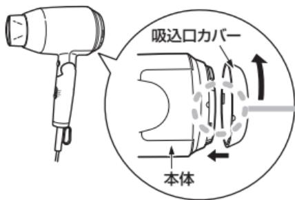
吸入口カバーの D 印が本体の C 印に合うまで回す。
