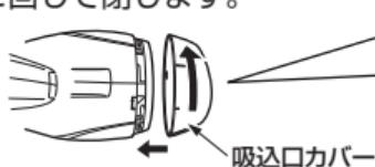
吸入口カバーの I 印と本体の ←印を合わせ、吸入口カバーの I 印が本体の I 印に合うまで回す。
