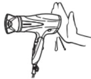
電源コードを傷付けたり、破損したり、加工したり、無理に曲げたり、引張ったり、ねじったりしない。また、重い物を載せたり、挟み込んだり、高温部に近づけたりしない。
