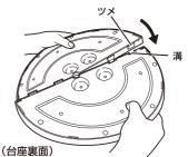
3 電源コードを台座の溝にはめ、台座の凸部と本体の凹部を合わせて本体に台座をはめ込み、台座取り付けネジ(4本)で取り付けます。
