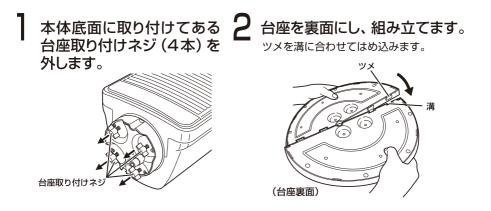
3 電源コードを台座の溝にはめ、台座の凸部と本体の凹部を合わせて本体に台座をはめ込み、台座取り付けネジ(4本)で取り付けます。
