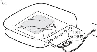
4. コントローラーの温度調節目盛を「強(ダニ退治)」の位置にし、約3時間通電する。
