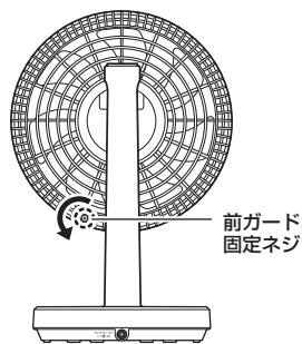
2 前ガードを反時計回りに回して取り外します。
