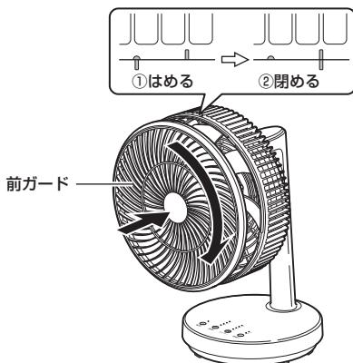
5 前ガード固定ネジを時計回りに回して締めます。
