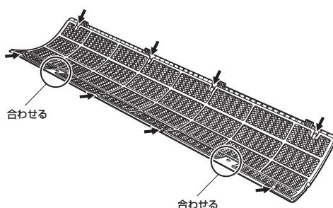
5 吸入口カバーを1と逆の手順で本体にはめ込み、吸入口カバー固定ネジを締めて取り付けます。
