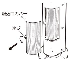
2 吸入口カバーのツメからフィルターを外します。
