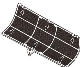
5 吸入口カバーを本体にはめ込み、ネジを締めて取り付けます。
