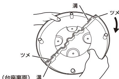
3 電源コードを台座の溝にはめ込み、台座取り付けネジ（4本）で取り
