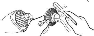
③お手入れが終わったら、吸入口フィルターを本体に押し込み右に回して取り付けます。
