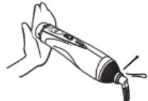
電源コードを傷付けたり、破損したり、加工したり、無理に曲げたり、引張ったり、ねじったりしない。また、重い物を載せたり、挟み込んだり、高温部に近づけたりしない。
