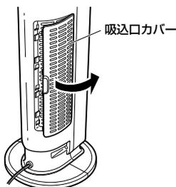
2 吸込口カバーのツメからフィルターと脱臭フィルターを外します。
