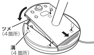
④ベース裏面にベース固定ネジを取り付けます。
