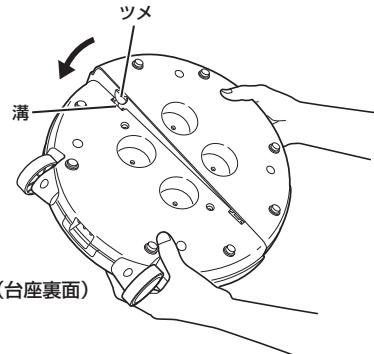
3 台座表面の凸部が本体正面の凹部に合うようにはめ込み、台座取り付けネジ(4本)で取り付けます。
