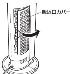
2 吸入口カバーのツメからフィルターと脱臭フィルターを外します。
