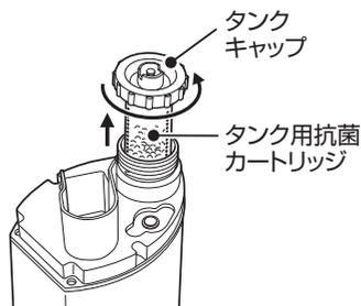
2 タンクキャップを外して新しい抗菌カートリッジを取り付けます。
