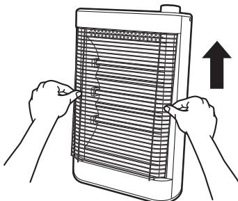
2 ガードの下方を手前に引き出して斜めに引き下げる。
