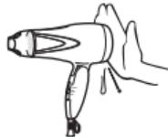
電源コードを傷付けたり、破損したり、加工したり、無理に曲げたり、引張ったり、ねじったりしない。また、重い物を載せたり、挟み込んだり、高温部に近づけたりしない。
