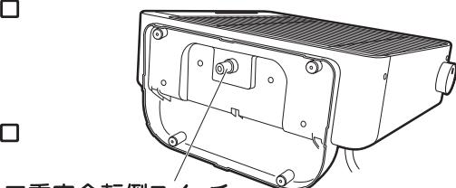
●本体が倒れたり、傾いたり、浮いたり、本体を持ち上げたときに、通電を止める働きをします。
