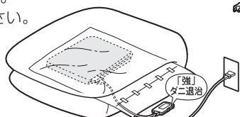
4. コントローラーの温度調節目盛を「強(ダニ退治)」の位置にし、約3時間通電する。
