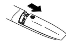
2 乾電池ケースの内側の表示に合わせて乾電池を入れ、乾電池カバーをはめます。
