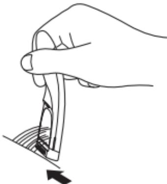
**3** カバーコーム・トリマー刃アタッチメントを本体から取りはずし、ネット刃アタッチメントを取り付けます。
