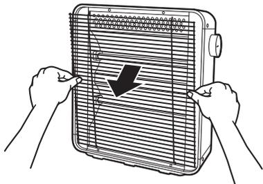
2 ガードの上方を手前に引き出して斜めに引き上げる。
