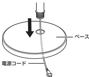
②電源コードを引き出しながら、スタンド取付穴の突起とスタンドの溝が合うようにはめ込みます。
