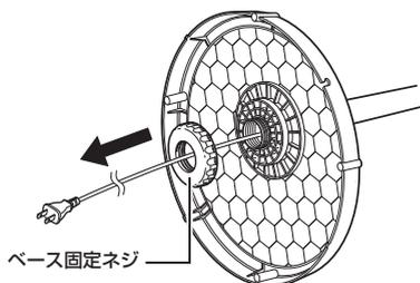
④底面からベース固定ネジを取り付け、電源コードの保護チューブ部分をベースの溝に通します。
