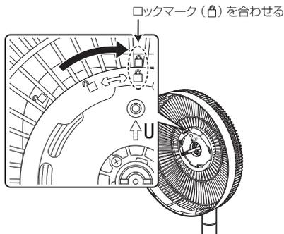
③後ガード固定ネジを付属のドライバーで締め付けます。
