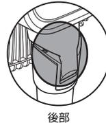
●組み立て時、電源コードを必ずベースの穴に通し、保護チューブ部分をベースの溝に通す。
