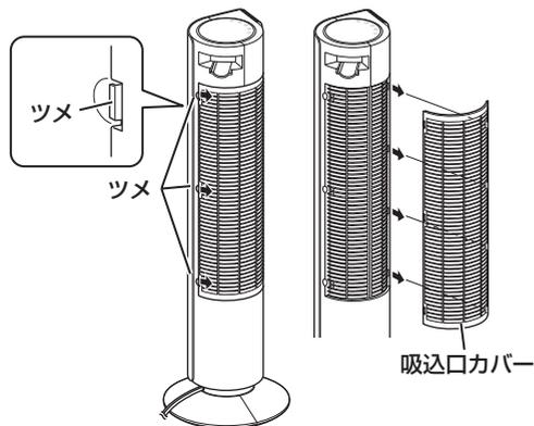
2 吸込口カバー内側のツメとフィルター押さえから①、②の順にフィルターははずします。
