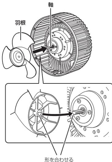
②スピナーを反時計回りに回して締め付けます。
