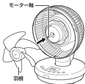
②スピナーを反時計回りに回して締め付けます。
