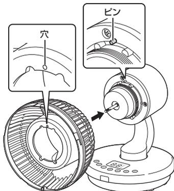
②後ガード固定ナットを時計回りに回して締め付けます。
