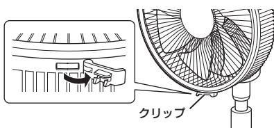
②前後のガードを印に合わせて反時計回りの方向に回し、前ガードをはずします。
