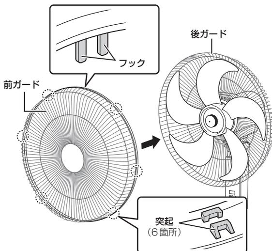
③前ガードのクリップを閉じ、前ガード固定ネジを取り付けます。
