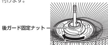
②後ガードの丸穴を、モーター部の凸部（3箇所）に合わせ、て差し込みます。
