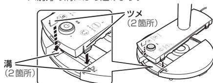
③本体後方のツメとベース後方の溝が合うようにはめ込みます。
