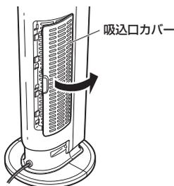
2 吸込口カバーのツメからフィルターと脱臭フィルターをはずします。
