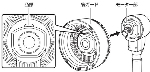
②後ガード固定ナットを時計回りに回して締め付けます。
