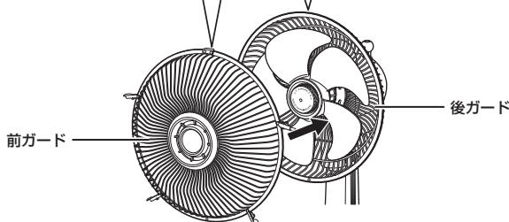
③前ガードと後ガードの全周を合わせ、前ガードのクリップ（4箇所）を閉じます。
