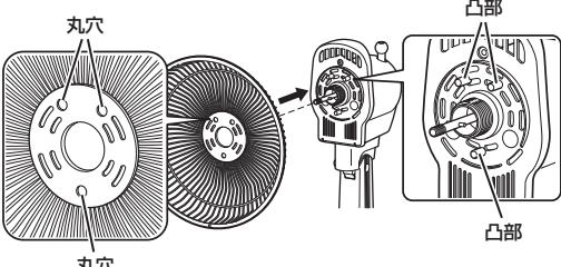
※梱包時、前ガードと後ガードの間に羽根を入れ、クリップで固定しております。組み立て前にクリップを開いて前ガードと後ガードを離し、羽根を取り出してください。
