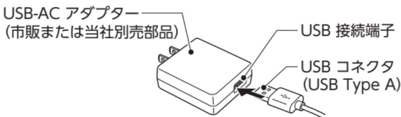
※市販のUSB-ACアダプターは、必ず定格出力DC5V 1Aのものを使用してください。
