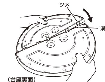
3 電源コードを台座の溝にはめ、台座の凸部と本体の凹部を合わせて
