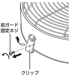
②前ガードの上部を支えながら、前ガードの下部を引き外します。
