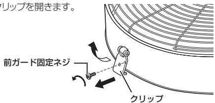
②前ガードのフックを後ガードに差し込み、前ガードの上半分のツメを後ガードにはめ込みます。
