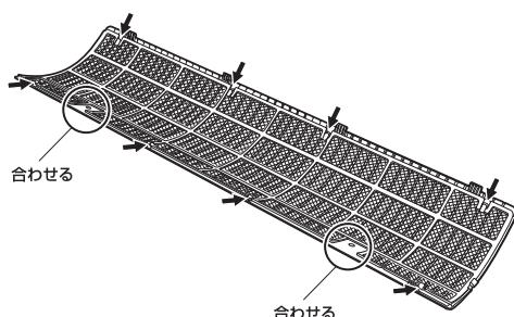
5 吸入口カバーを1と逆の手順で本体にはめ込み、吸入口カバー固定ネジを締めて取り付けます。
