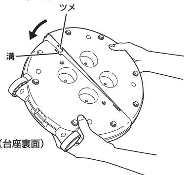
3 台座表面の凸部が本体正面の凹部に合うようにはめ込み、台座取り付け
