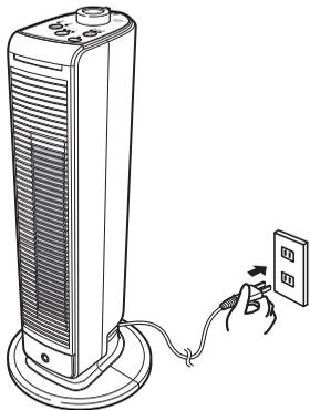
**使用後は** 「電源」つまみを [切] にして電源を切り、電源プラグをコンセントから抜く。
