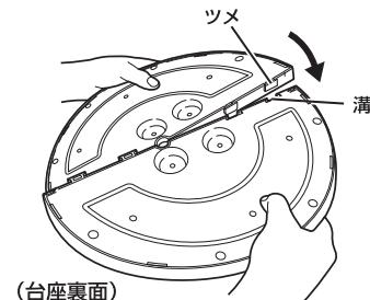
3 電源コードを台座の溝にはめ、台座の凸部と本体の凹部を合わせて
