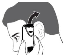
本体を傾けて、刃の一端だけが触れるようにして毛先だけをカットすると、きれいに仕上がります。
