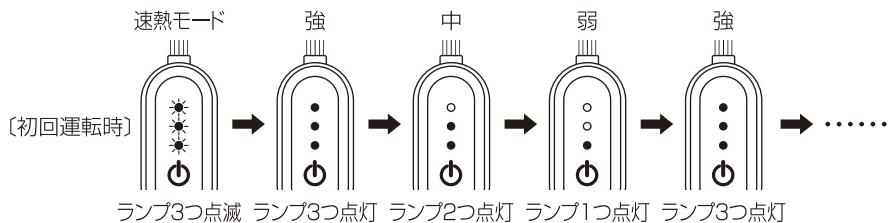
※運転開始後、2時間経過すると自動的に運転が停止します。(2時間自動OFFタイマー)
