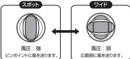
※インナーノズルはアウターノズルと連動して回転させることができます。
